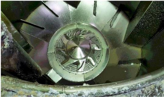
工場では約100名の方が24時間3交代で作業に当たっておられます。古紙問屋から原料の古紙が搬入されますが、小ロット多品種(60~80種類)の紙が製造できる工場です。製紙工場としては、均一の原料で同じ製品を大量に生産する方が生産性もいいのですが、この工場では難処理古紙にも対応可能のようにパルパー(原料離解)が9台あるそうです。通常の製紙工場では2台程度で対応しているそうです。
