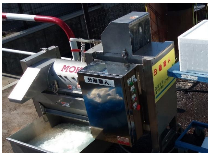
モキ破袋分別機「分離職人」 M155 型 原動機 1.5 kw
